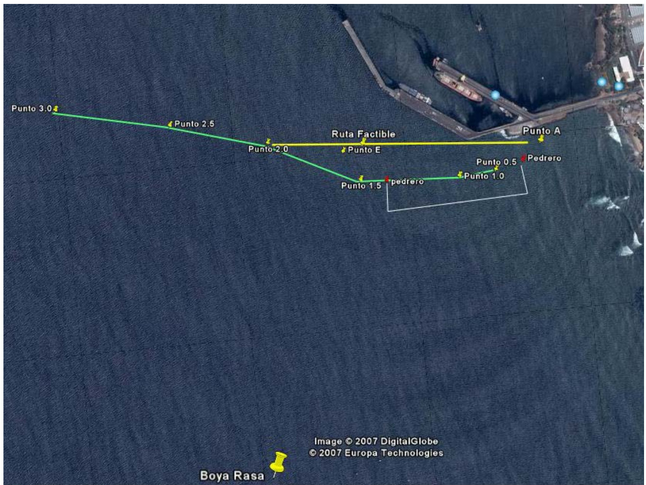
Fig. 1. Ubicación geográfica de los puntos de interés para la colocación submarina de la tubería. La ruta color amarillo refleja la zona factible para el trazo submarino de la tubería conectando con el punto 2.0.
